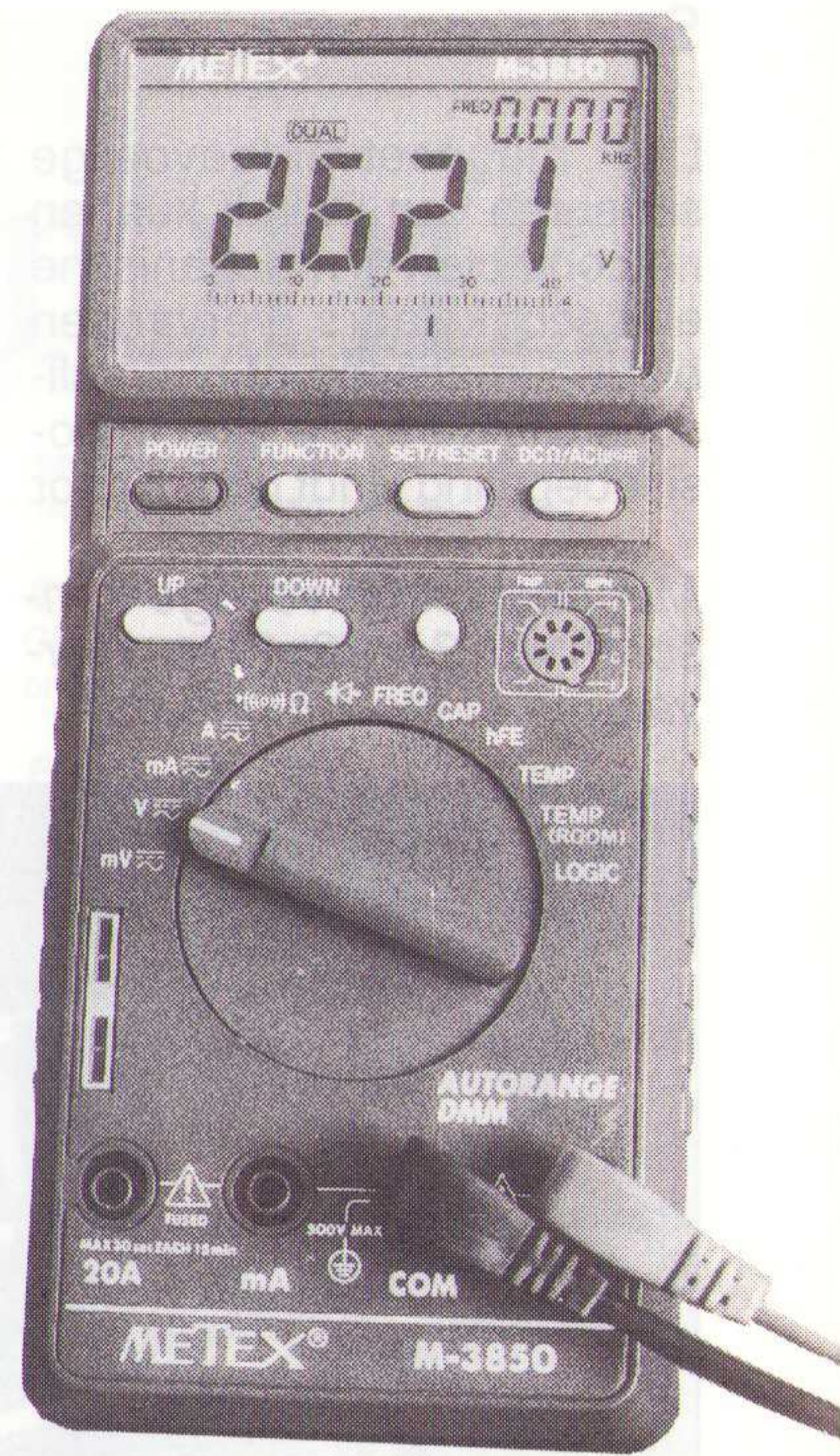
Twee meetwaarden, bijvoorbeeld spanning en frequentie, tegelijk aflezen.
